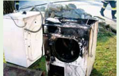
Vermutlich ein defekter Wäschetrockner löste den Brand aus.
