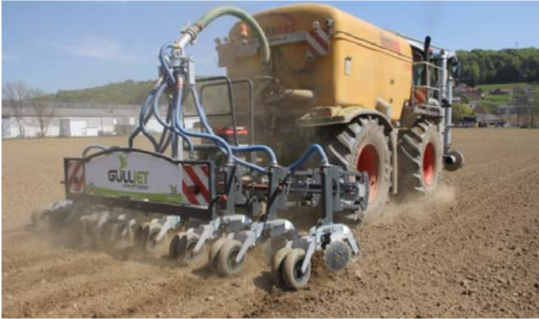
Der Gülletrack im Einsatz mit dem neu entwickelten „Güllejet“. Hier werden 8-reihig (je nach Einstellung) 10-50 m 3 /ha exakt in 20cm Bodentiefe eingeschlitzt.
