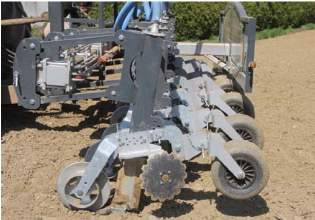
Das Arbeitswerkzeug ist ein sehr schmaler, hohler Eisenzinken mit einer Hohlräumformenden Spitze. Die Gülle wird durch dieses Werkzeug durchgepumpt und in den geformten Tunnel abgelegt. Vorne ist ein Schneidrad, dahinter ein Krümmler und weiter dahinter sind zwei Andrückwalzen montiert.
