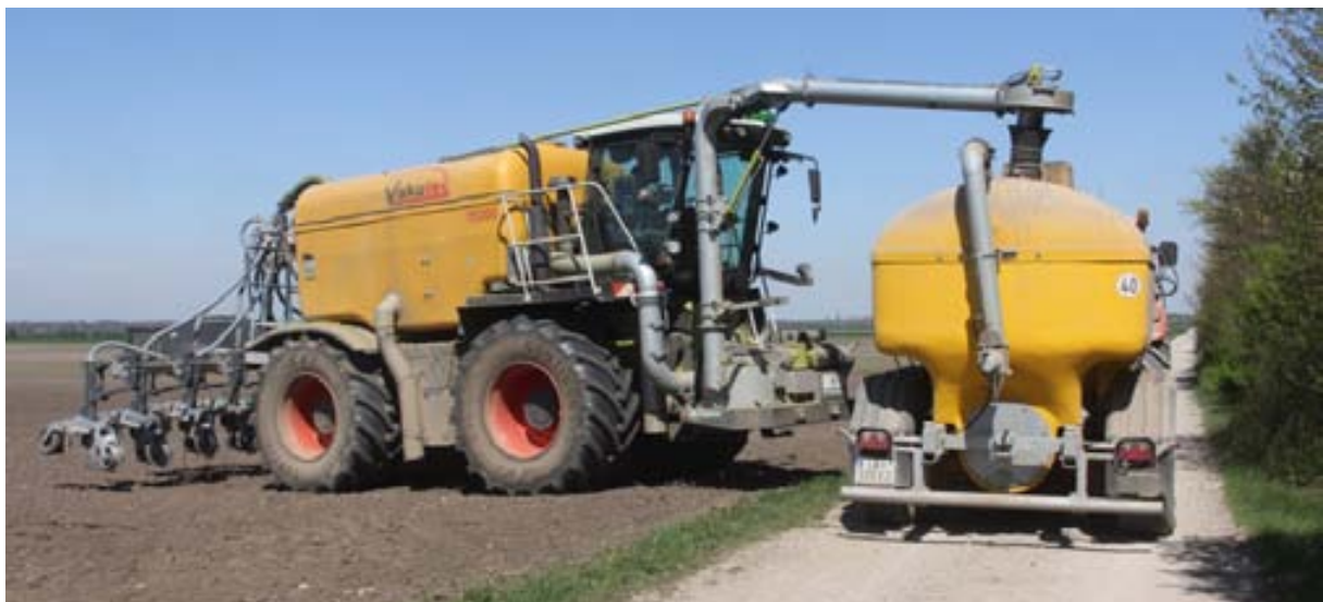
Bei der Entnahme durch den Gülletrack wurde die Gülle 2 Mal zurückgepumpt, um eine homogene Gülle-Kohle-Mischung zu erhalten.
