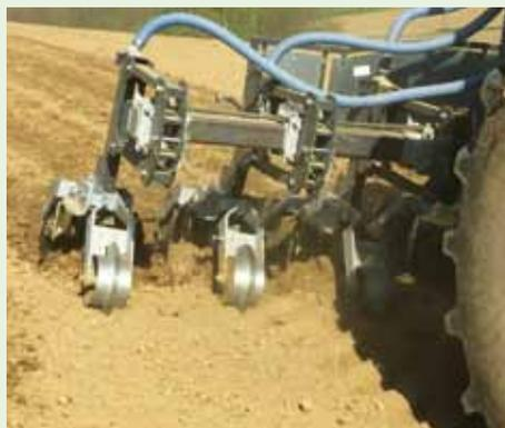
Das neue Gerät schlitzt ein Kohle-Gülle-Gemisch in den Boden ein.
